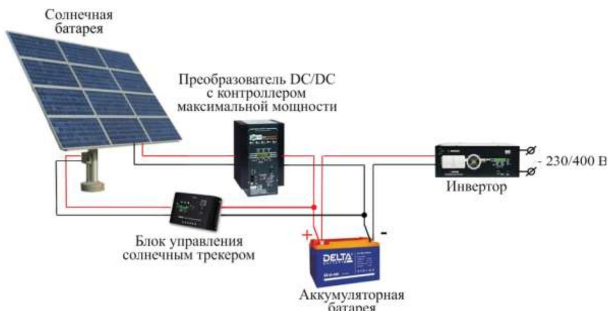
Рисунок 14 – Модель фотоэлектрической солнечной электростанции
