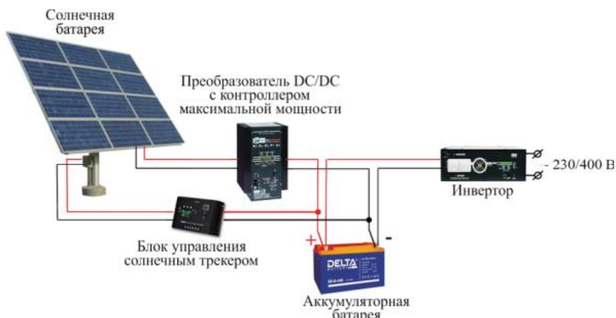
Рисунок 14 – Модель фотоэлектрической солнечной электростанции
