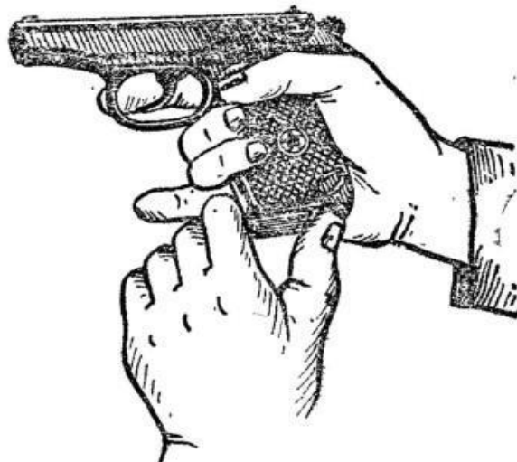
Рис. 3. Извлечение магазина из основания рукоятки
