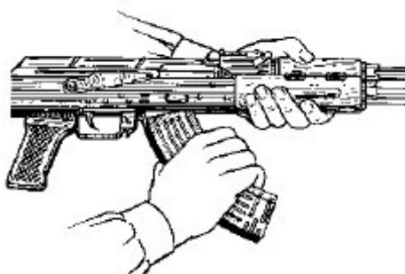
Рис. 19. Присоединение газовой трубки
