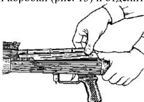
Рис. 13. Отделение крышки ствольной коробки
