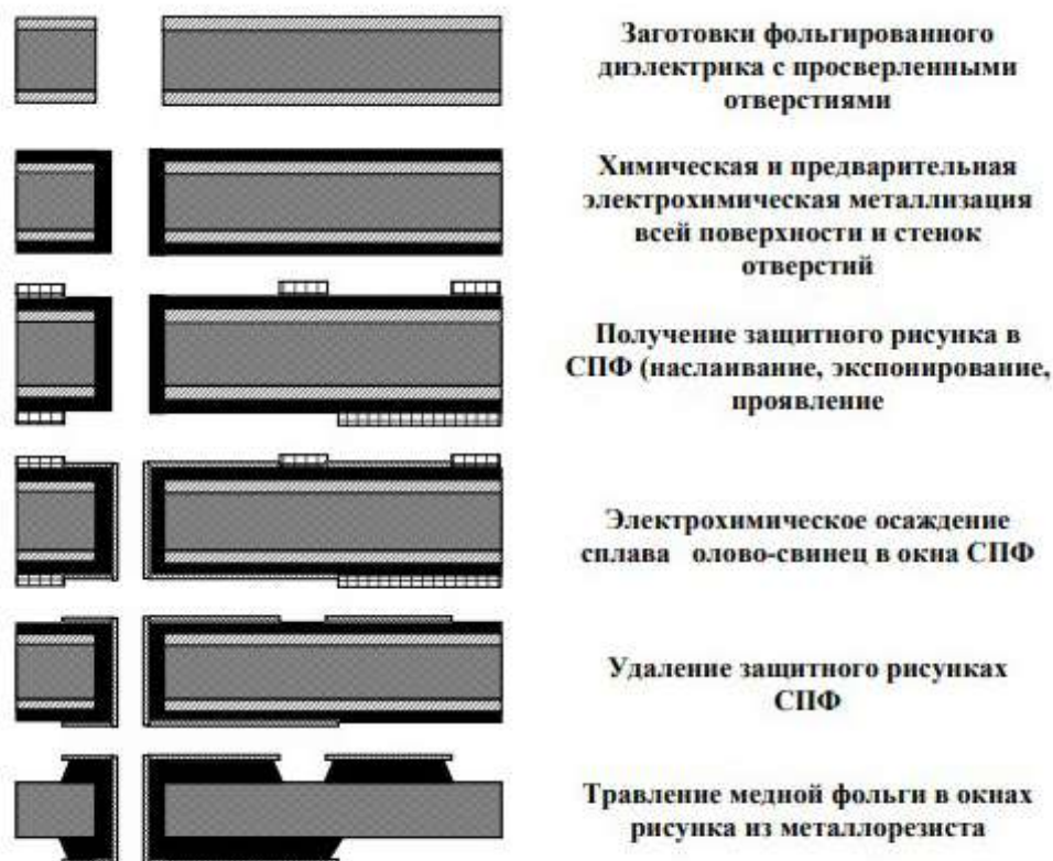
Рис.4. Изготовление ПП субтрактивным позитивным методом с использованием металлорезиста
