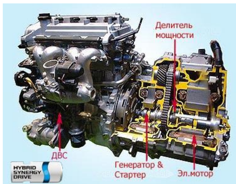
Рис. 6. Общий вид силового агрегата с последовательно-параллельной схемой гибридного привода (Компания Toyota)
