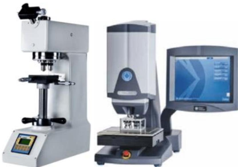
*Рисунок 2.5 - Твердомеры Виккерса*
