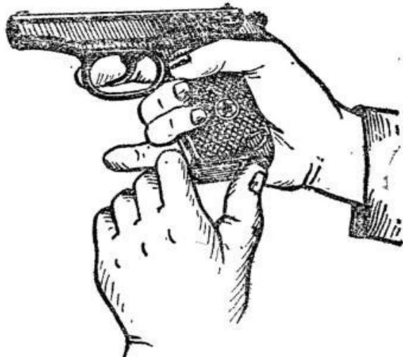
Рис. 3. Извлечение магазина из основания рукоятки
