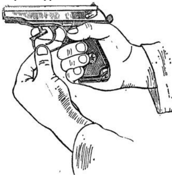
Рис. 4. Оттягивание спусковой скобы
