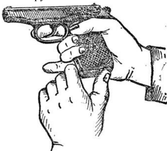
Рис. 3. Извлечение магазина из основания рукоятки
