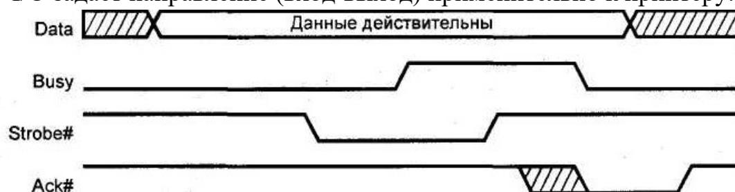
Рис. 3.1 – Передача данных по протоколу Centronics
