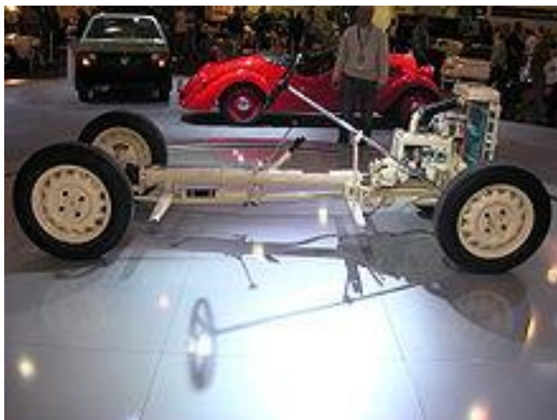
Рис.7.3. Рама довоенного автомобиля «Шкода» с подmotorной вилкой в передней части
