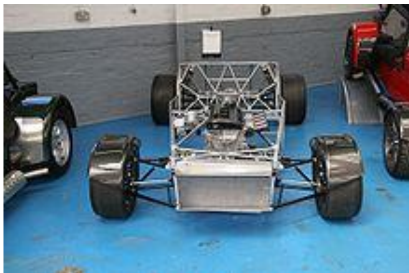
Рис.7.4. Решетчатая рама спортивного автомобиля
