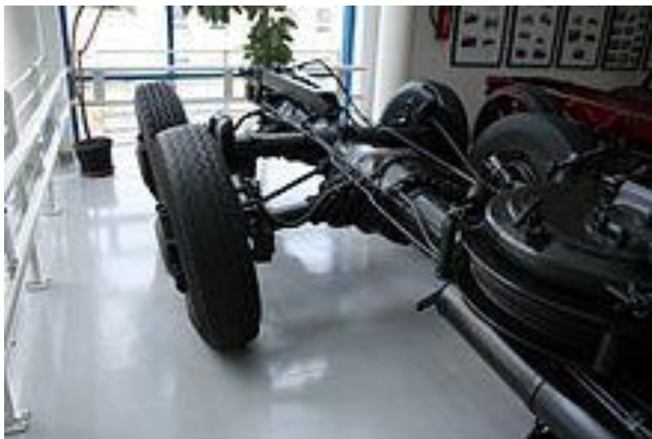
Рис.7.2. Хребтовая рама грузовика «Татра»
