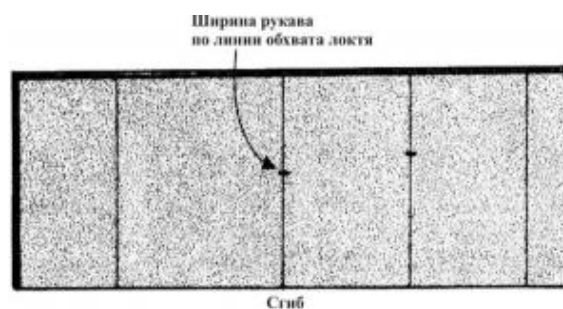
Рисунок 27 – По линии локтя отложить ширину рукава, равную половине обхвата руки в локте, плюс прибавка на свободу облегания 2 см
