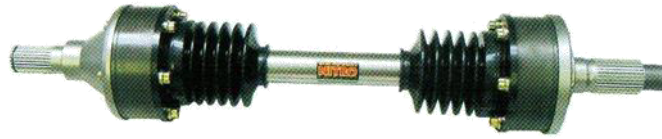
Рисунок 2. Тюнинг-овый ведущий вал с усиленными шарнирами равных угловых скоростей
