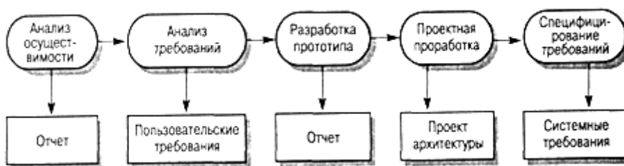
Рисунок 4.1 - Этапы процесса разработки спецификации
