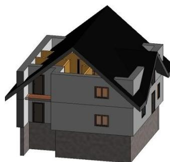
Далее перейдите из 3D-вида на вид Спереди. Выделите кровлю и в свойствах задайте Смещение от уровня 500 мм. Затем, используя секущую рамку и фильтр, выделите только стены второго этажа и присоедините их к кровле. Удалите те окна, которые вылезли за края кровли.
