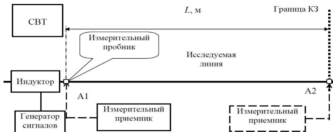
Рисунок 1 - Схема измерения реального затухания в линии
