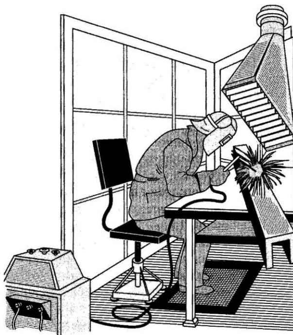
Рис. 6.1. Рабочее место электросварщика
