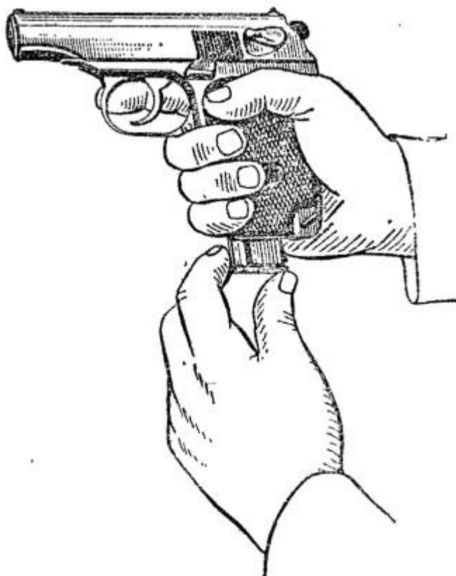
Рис. 8. Вставление магазина в основание рукоятки
