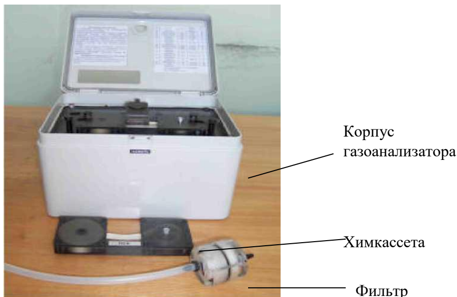
Рисунок 3.2 – Общий вид газоанализатора ГАНК-4
