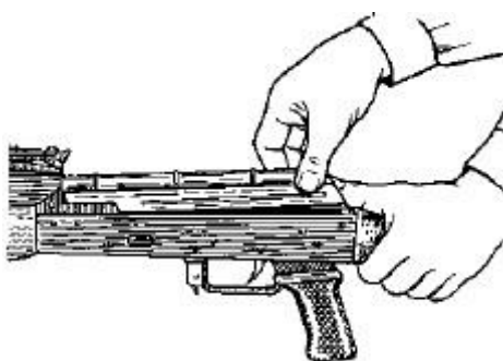
Рис. 13. Отделение крышки ствольной коробки
