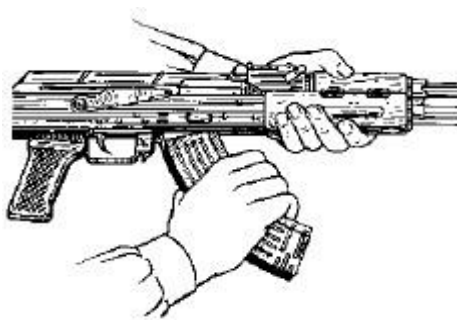
Рис. 19. Присоединение газовой трубки
