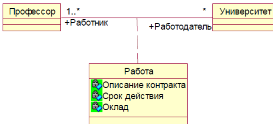
Рисунок 1.6 - Структура объектно-ориентированной программы в виде связанных классов
