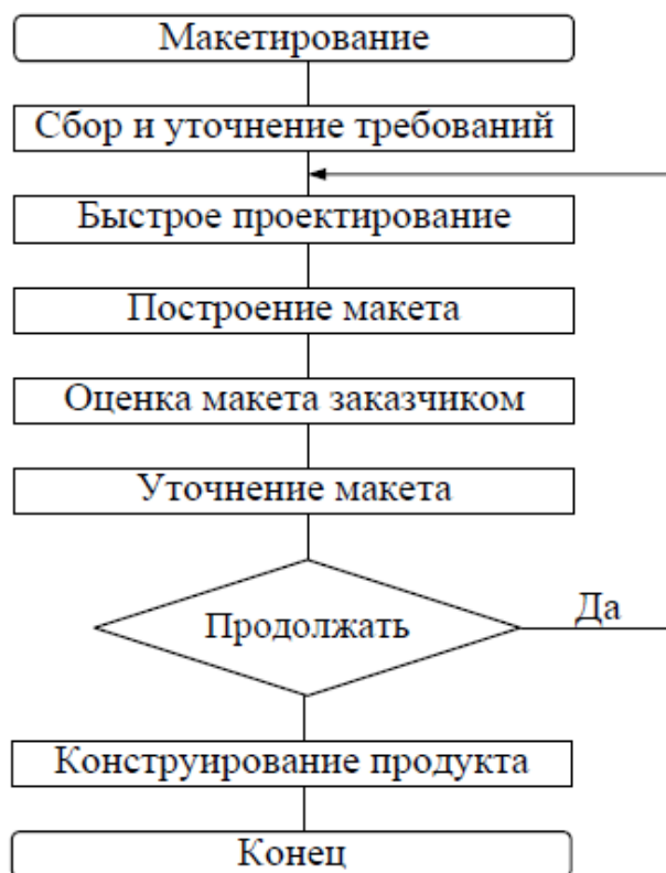
Рисунок 1.13 - Последовательность действий при макетировании
