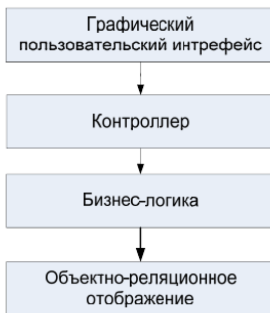
Рисунок 6.1 - Трехслойная архитектура с контроллером
