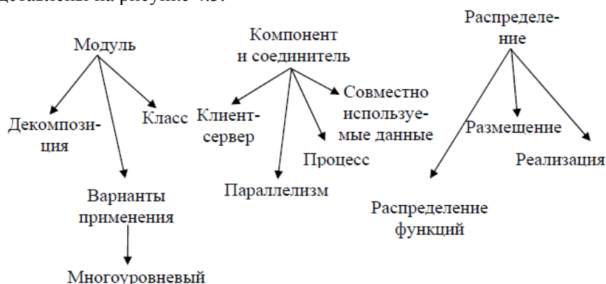
Рисунок 4.3 - Стандартные структуры программной архитектуры
