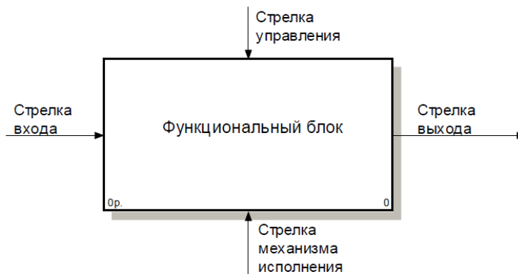
Рисунок 2.19 - Соединение стрелок со сторонами функционального блока
