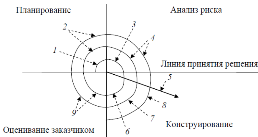
Рисунок 1.11 - Спиральная модель: 1 – начальный сбор требований и планирование проекта; 2 – та же работа, но на основе рекомендаций заказчика; 3 – анализ риска на основе начальных требований; 4 – анализ риска на основе реакции заказчика; 5 – переход к комплексной системе; 6 – начальный макет системы; 7 – следующий уровень макета; 8 – сконструированная система; 9 – оценивание заказчиком
