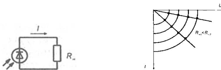
Рис.5 Включение фотодиода в режиме фото ЭДС световая характеристика фотодиода
