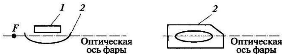
Рис. 6.2. Размещение нити накала ближнего света в фаре европейской системы светораспределения: 1 — нить ближнего света; 2 — корытообразный экран
