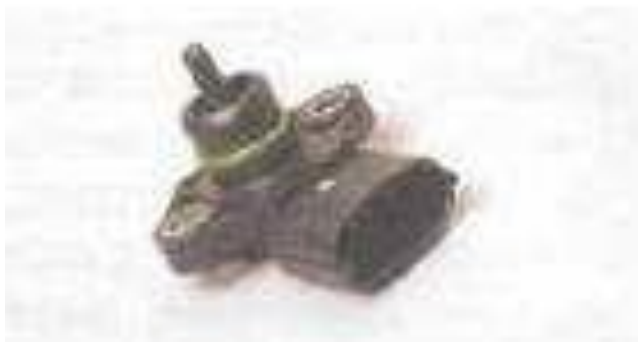
Датчик абсолютного давления и температуры воздуха во впускном трубопроводе
