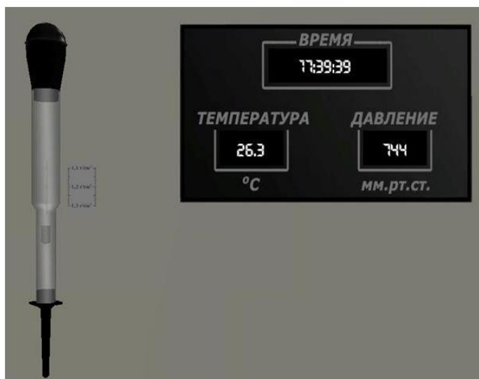
Рис. 4.1. Денсиметр после замера плотности электролита
