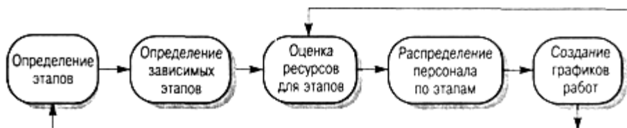
Рисунок 4.2 - Процесс составления графика работ
