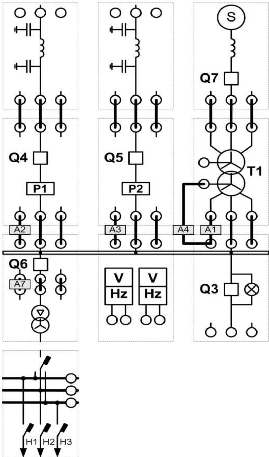
Рисунок 6.1 – Принципиальная схема «Балансирующий узел нагрузкой»
