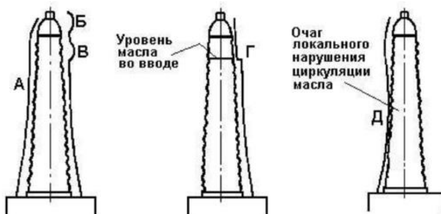
Рисунок 3 - Характер распределения температуры по высоте маслонаполненного ввода.
