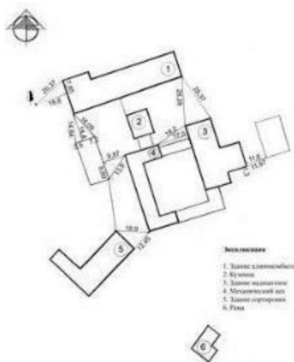
Рисунок 3 – Пример обмера генерального плана.
