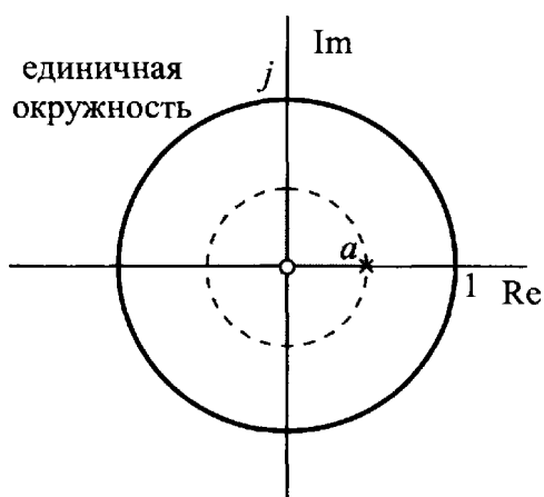
Рисунок 4. Схема нулей и полюсов в ОС.
