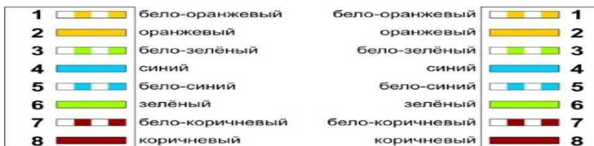
Рис. 1. Схемы обжимки кабеля: а - прямой кабель
