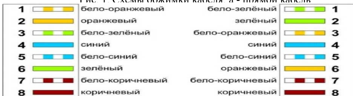
Рис. 1. Схемы обжимки кабеля: а - прямой кабель
