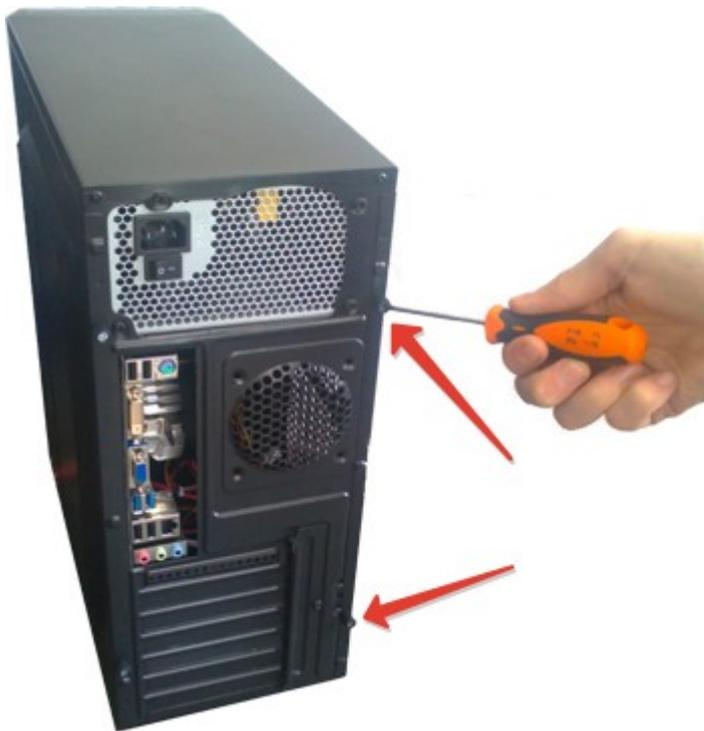
Откручиваем винты крепления крышки
