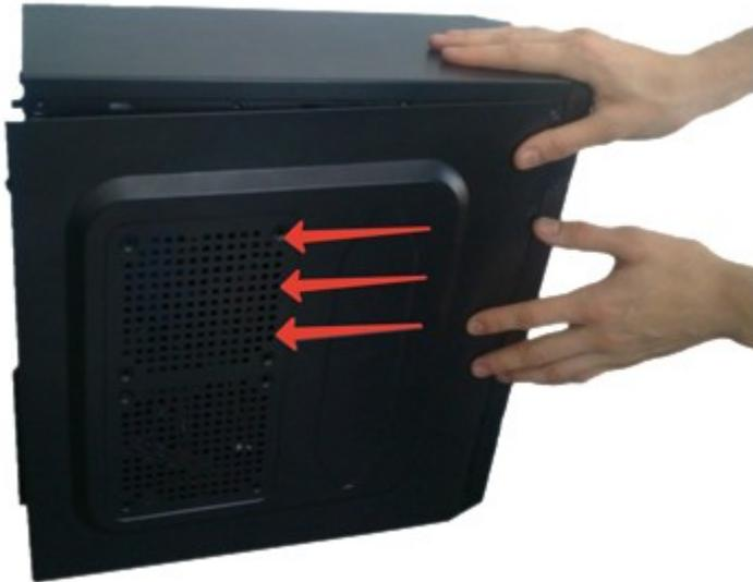
Снимаем крышку системного блока компьютера
