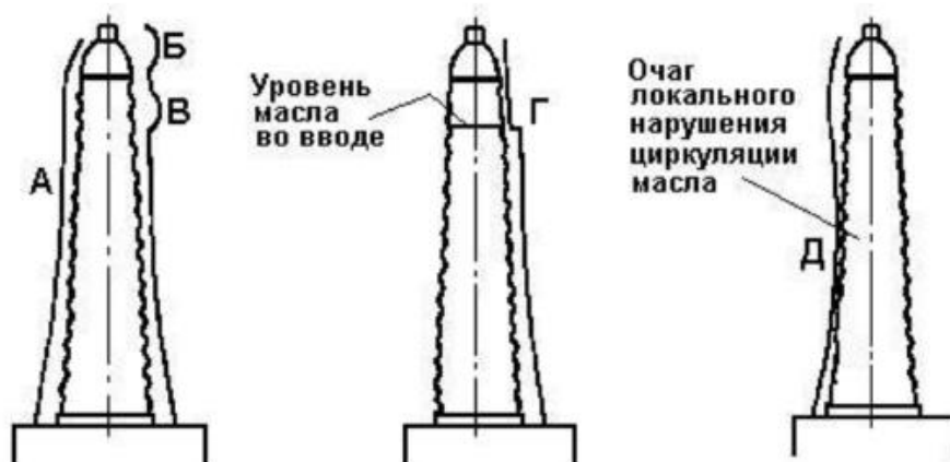
Рисунок 3 - Характер распределения температуры по высоте маслонаполненного ввода.
