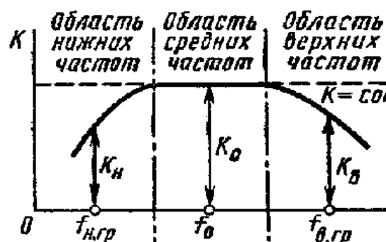
Рис.2 Амплитудно-частотная характеристика усилителя
