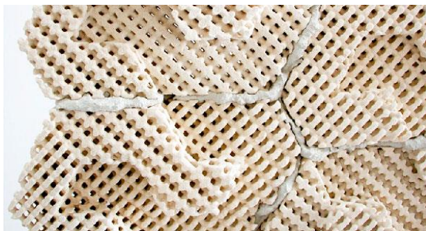
Рисунок 1. Новый стройматериал - кирпич с охлаждением
