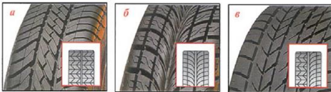
Рис. 1 Дорожные шины с разными типами рисунка: а – ненаправленный; б – направленный; в – ассиметричный
