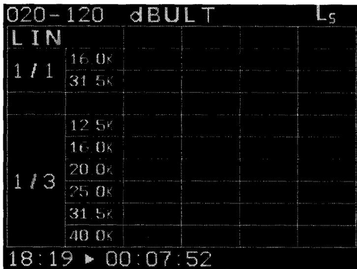
Рисунок 17 - ЖКИ с табличным выводом текущих УЗД
