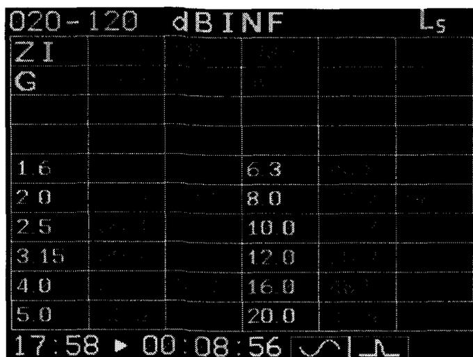
Рисунок 13 - ЖКИ с табличным выводом текущих значений параметров инфразвука
