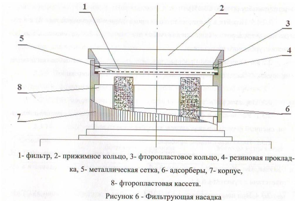
Для установки адсорберов с активированным углем 6 вывернуть фильтрующую насадку, снять с адсорберов защитные колпачки, вставить до упора в отверстие фторопластовой кассеты 8 неразъемные концы адсорберов. Завернуть до упора фильтрующую насадку.
