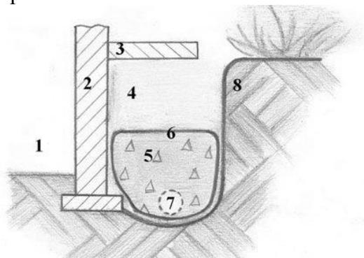
Рис. 1. Схема устройства пристенного дренажа
