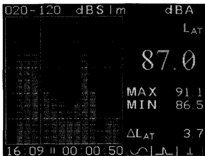
Рисунок 7 - Индикация в режиме dB SIm
