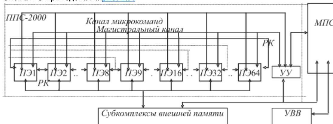
Рис. 1.9. Схема ВС ПС-2000
