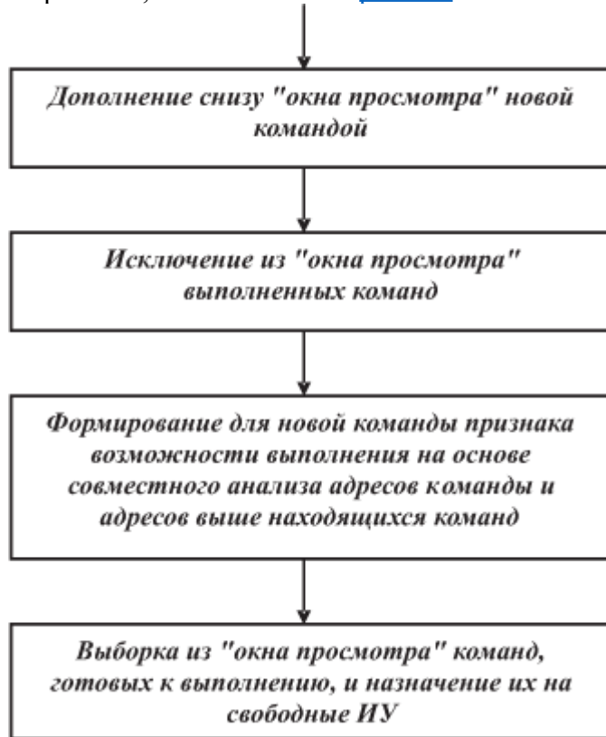
Рис. 2.3. Схема оптимизатора-компоновщика "длинных" командных слов
