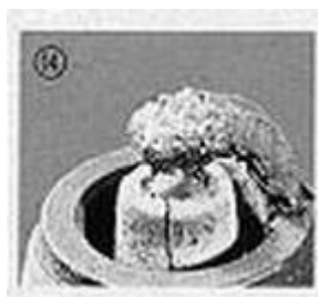
Рис. 14. Расплавленный центральный электрод.
