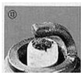
Рис. 13. Оплавленный центральный электрод.
