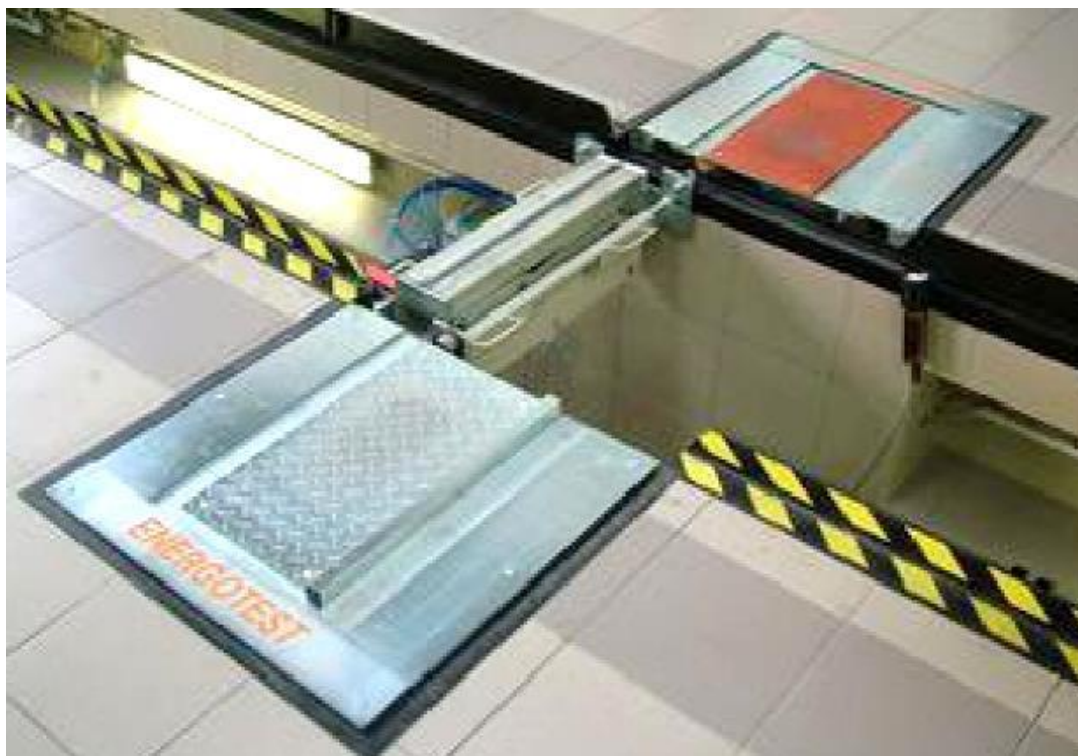
Рисунок 7. Общий вид детектора люфтов в подвеске автомобиля
