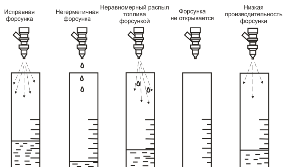
Рис. 27. Возможные варианты тестирования форсунок.
