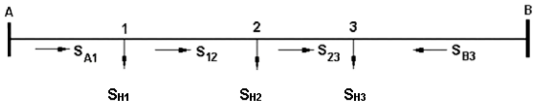
Рисунок 14.2 – Представление принципиальной схемы сети кольцевого типа сетью с двухсторонним питанием
