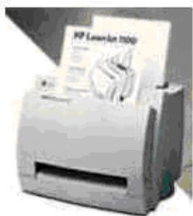
**Лазерный принтер** После засветки на барабан, находящийся под электрическим напряжением, наносится красящий порошок — тонер, частицы которого налипают на засвеченные участки поверхности барабана. Принтер с помощью специального горячего валика протягивает бумагу под барабаном; тонер переносится на бумагу и "вплавляется" в неё, оставляя стойкое высококачественное изображение. Цветные лазерные принтеры пока очень дороги.
