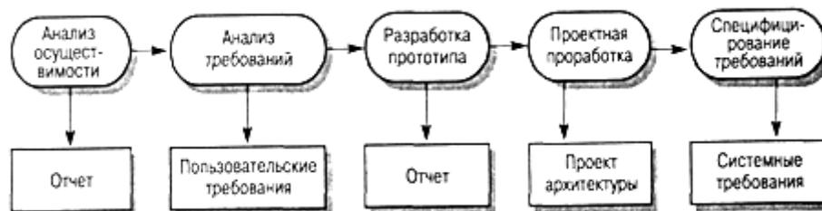
Рисунок 4.1 - Этапы процесса разработки спецификации
