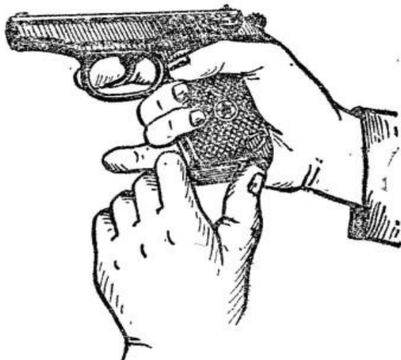
Рис. 3. Извлечение магазина из основания рукоятки
