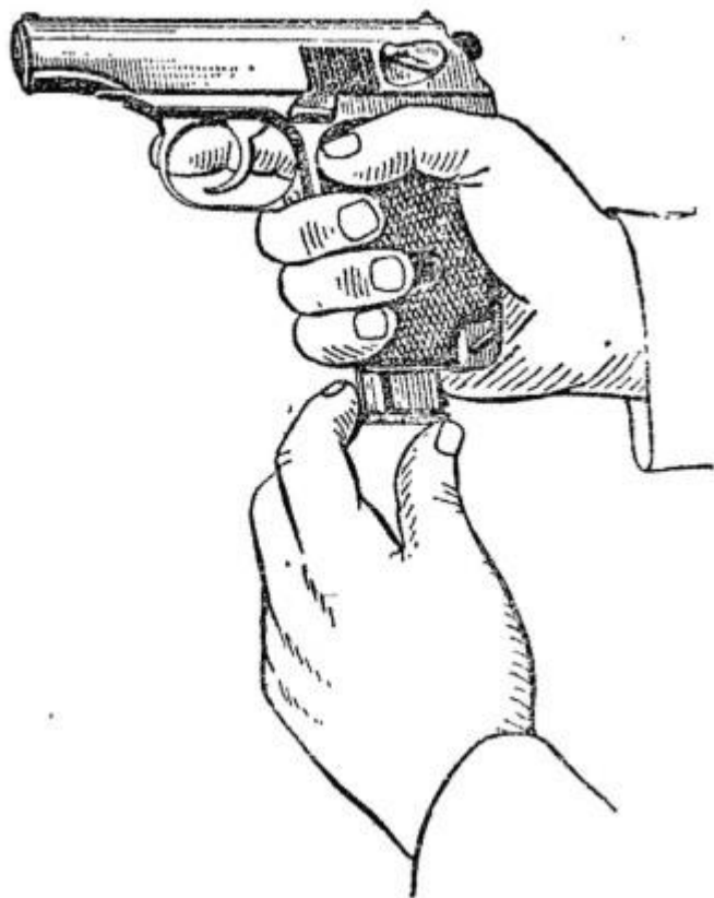
Рис. 8. Вставление магазина в основание рукоятки
