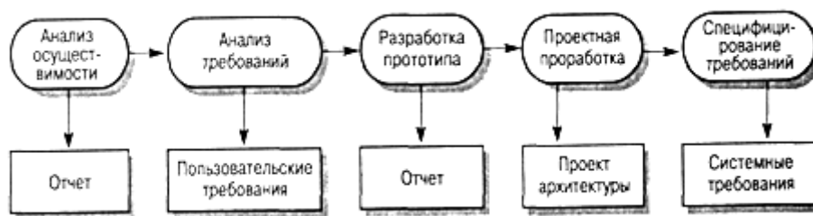
Рисунок 4.1 - Этапы процесса разработки спецификации
