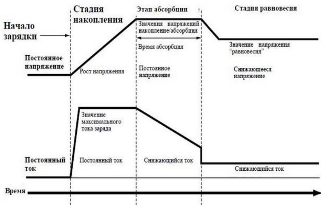
Рисунок 12 – Стадии управления зарядки АКБ
