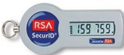
*Аппаратный токен RSA SecurID генерирует новый код каждые 30 секунд.*
