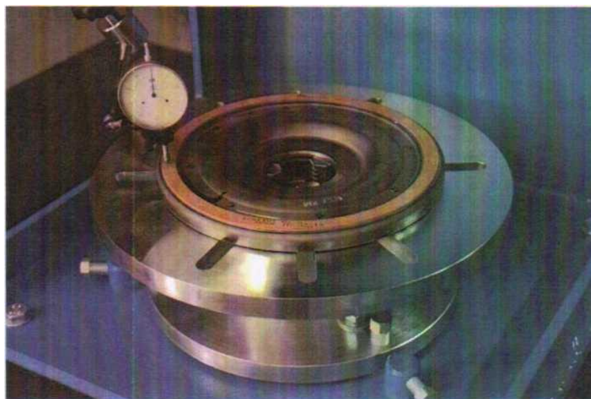
Рисунок 6 – Проверка качества наклейки фрикционной накладки на поворотном столе сварочного станка
