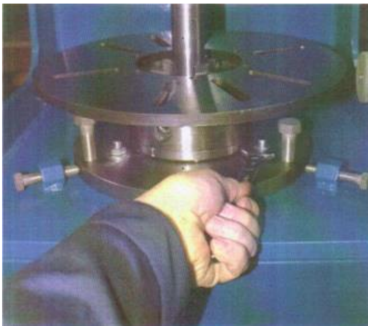
Рисунок 15 - Прижимные болты для фиксации настроек.
