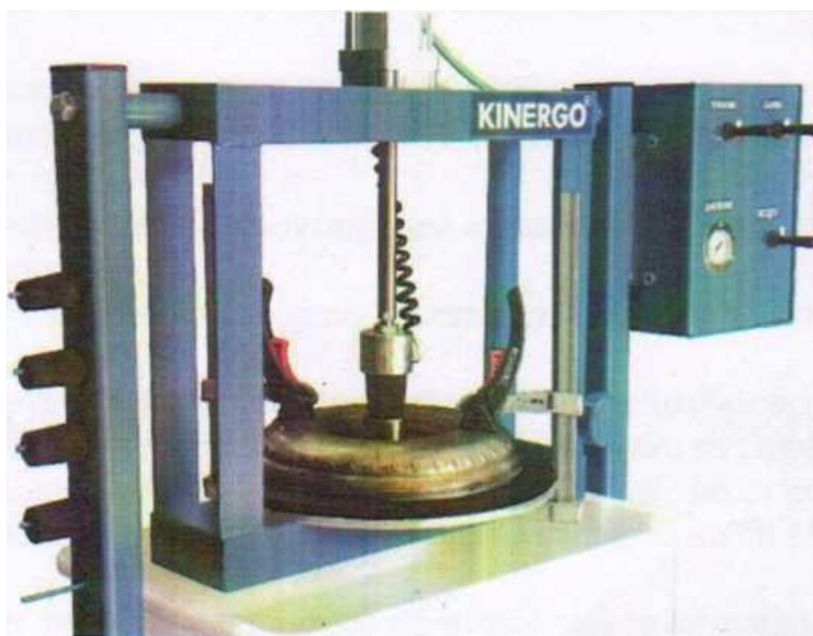
Рисунок 5 – Проверка герметичности соединения гидротрансформатора
