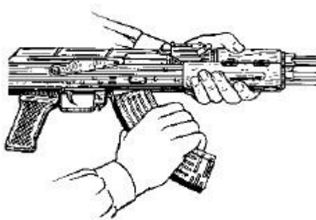
Рис. 19. Присоединение газовой трубки
