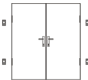
Рисунок 7 - Вариант размещения акустических излучателей для защиты дверного проёма с двумя створами.
