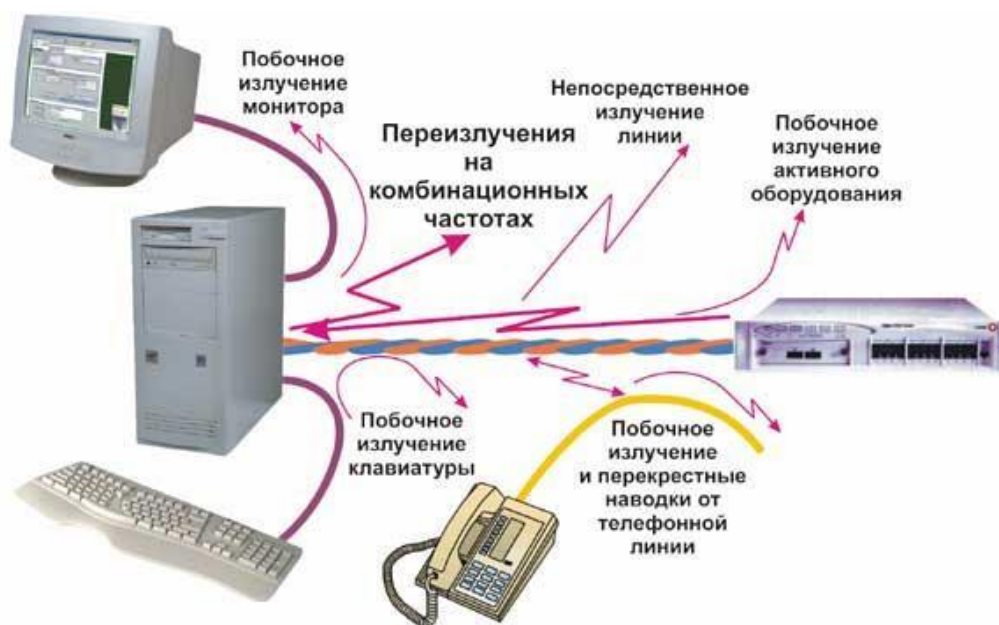
Рис 3.1 Основные источники возникновения ПЭМИ при работе СВТ
