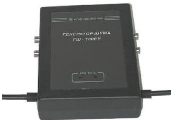
Рисунок 3.6 – внешний вид генератора шума ГШ-1000У
