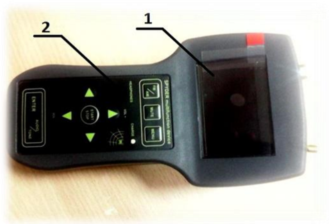
Рисунок 2.6 – Многофункциональный поисковой прибор «Спайдер» (лицевая часть).
