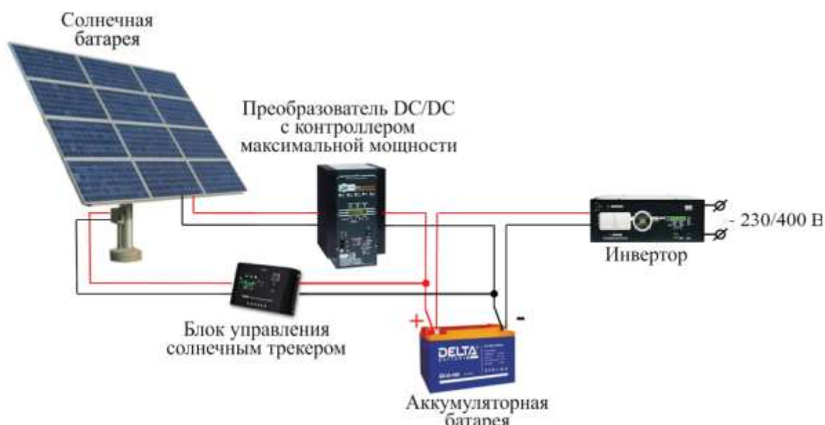
Рисунок 14 – Модель фотоэлектрической солнечной электростанции
