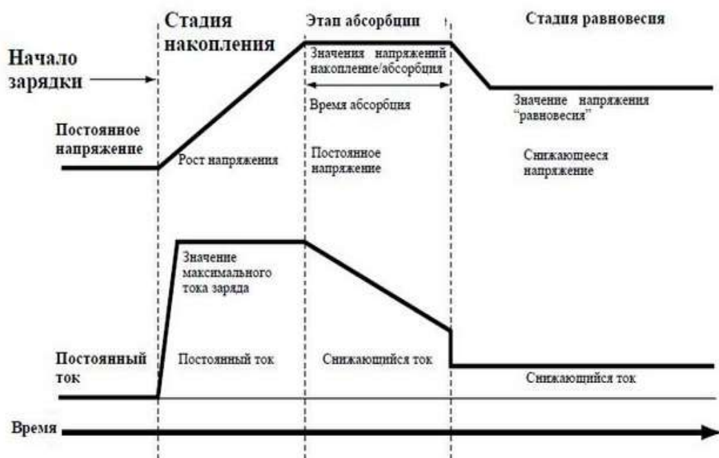
Рисунок 12 – Стадии управления зарядки АКБ
