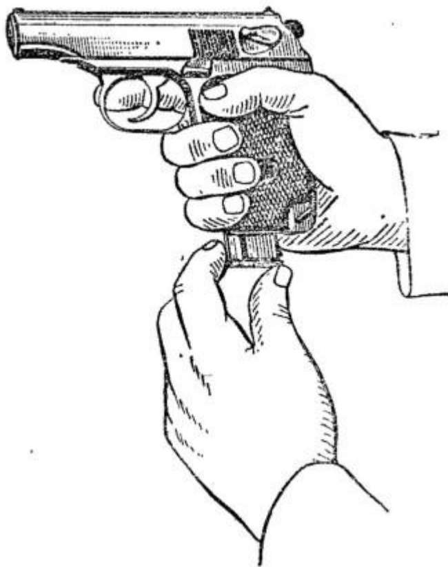
Рис. 8. Вставление магазина в основание рукоятки
