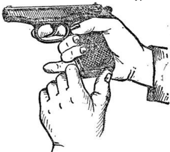
Рис. 3. Извлечение магазина из основания рукоятки
