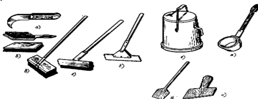
Рис.4. Инструменты и инвентарь, применяемые при устройстве гидроизоляции:
